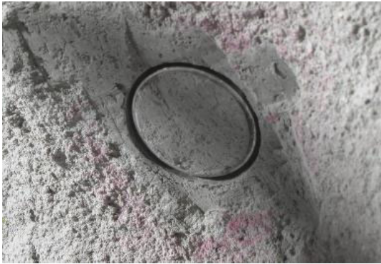
採土管による試料採取
